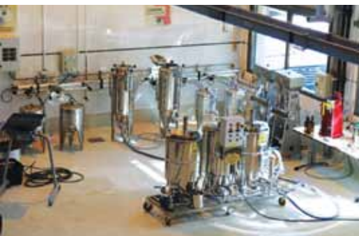
Microbrasserie, avec la brasserie (en premier plan), les six fermenteurs (en arrière-plan), une embouteilleuse et une capsuleuse (à droite).
