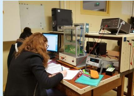
Chaîne de mesure numérique : capteur de niveau à flotteur
