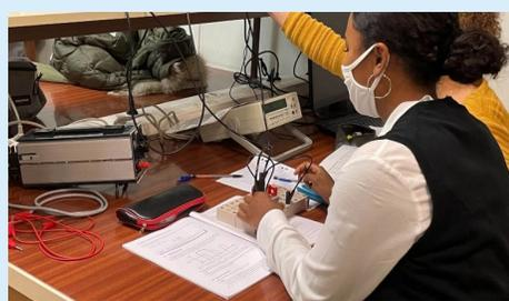
Utilisation de l'oscilloscope : charge et décharge d'un condensateur
